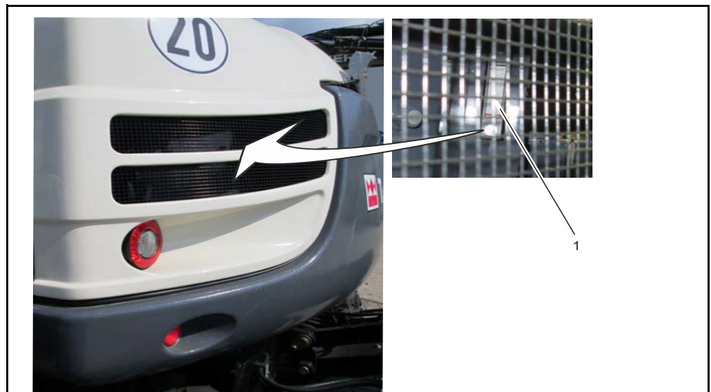
Afb. 6-25 Tank voor hydraulische olie - peilvenster
